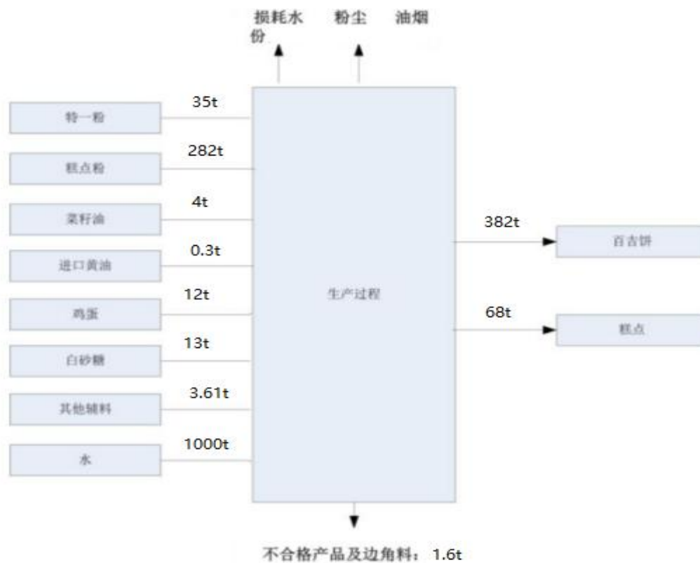
图4 生产过程中物料平衡图 (t/a)
